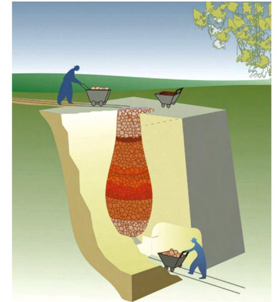
Schéma d'un four à chaux vertical à cuisson continue.
