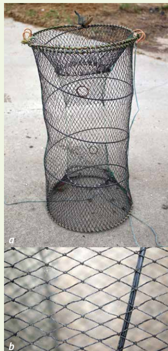
Figures 102a et 102b. Nasse pliable, à mailles en losange de 10 mm. Photos ©A. Martin
