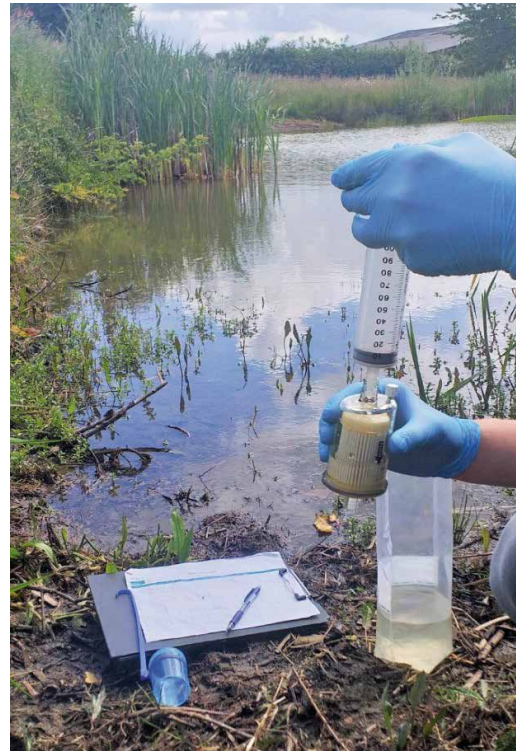
Figure 63. Filtration de l'eau prélevée dans le cadre d'une méthode ADNe. Photo ©A. Martin
